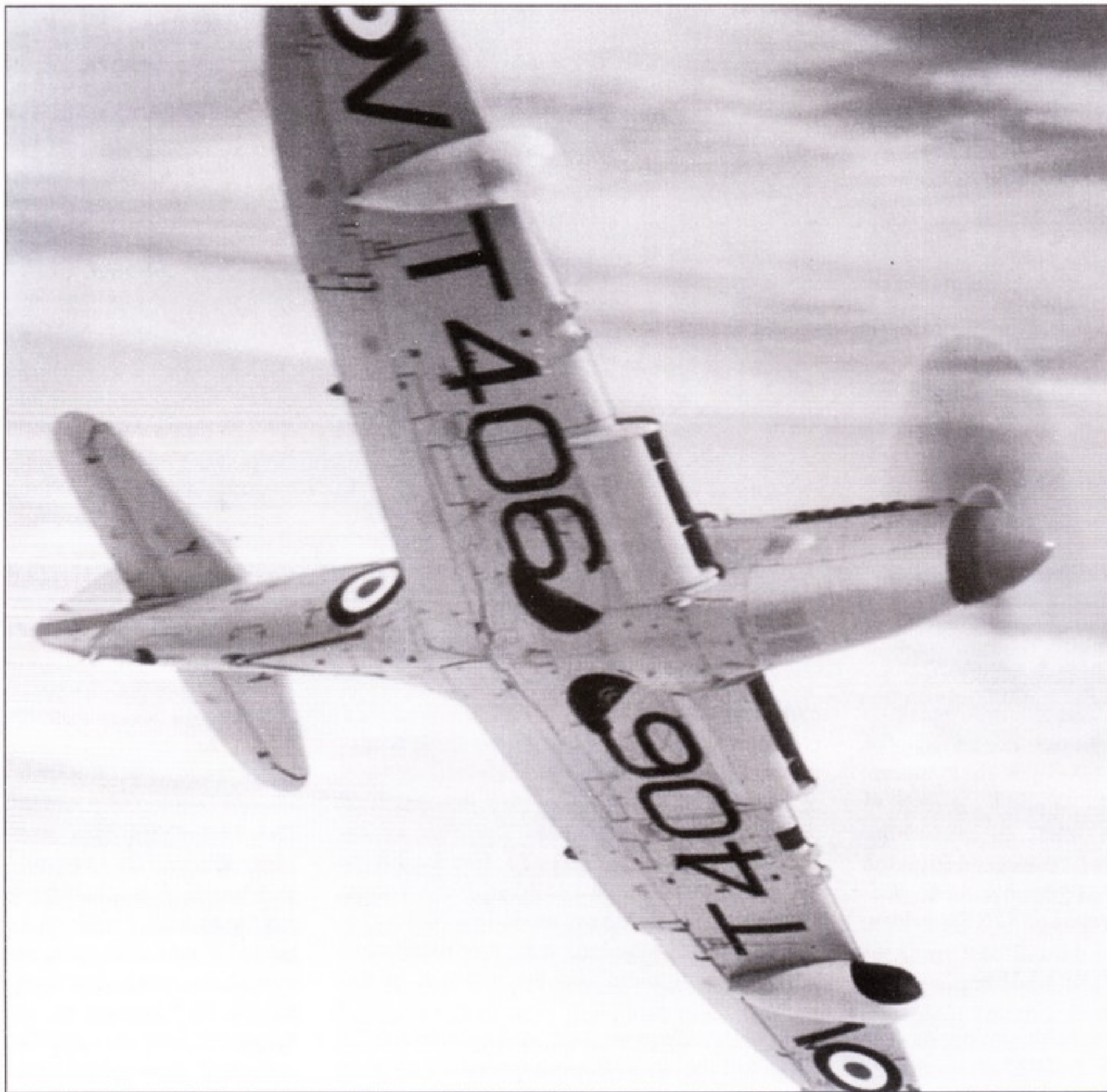
На этом снимке «Файрфляя» AS.5 VT406 хорошо виден тормозной крюк, посадочные щитки и воздухозаборники радиатора в передней кромке крыла.
