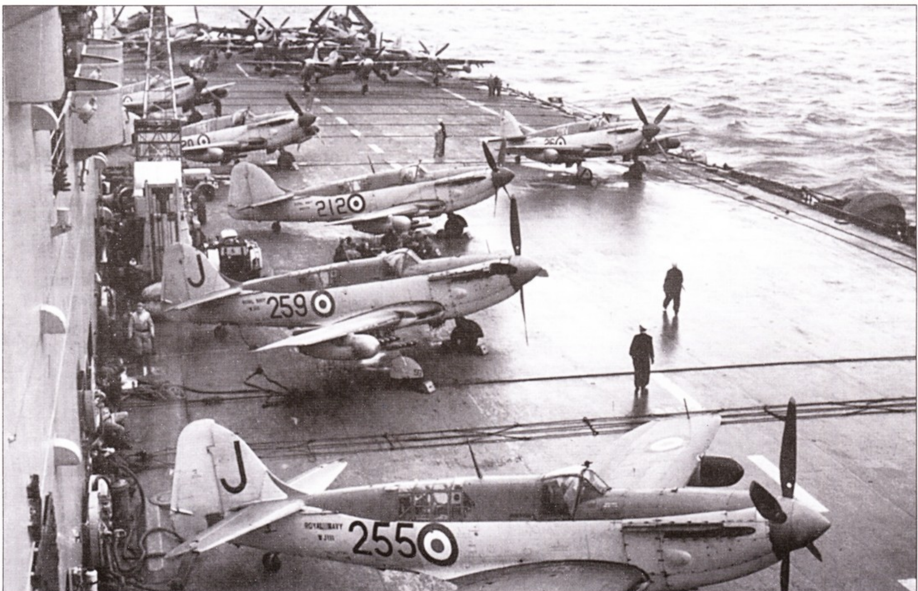
«Файрфлай» AS.6 из 812-й и 814-й эскадрилий готовятся к учебным стрельбам 76-мм НУРСами, авианосец «Игл», 1953 год. Самолеты по максимуму загружены ракетами - по восемь штук под каждой консолью крыла. Установлены пламезащитные щитки для ночных полетов. На корме видны «Си Хорнет» NF.21 809-й эскадрильи, еще несколько «Файрфлаев» и два самолета Дугласа AEW.1 (AD-4W) «Скайрейдер» - сорок машин этого типа были переданы FAA в рамках программы MDAP (Mutual Defense Assistance Program).
