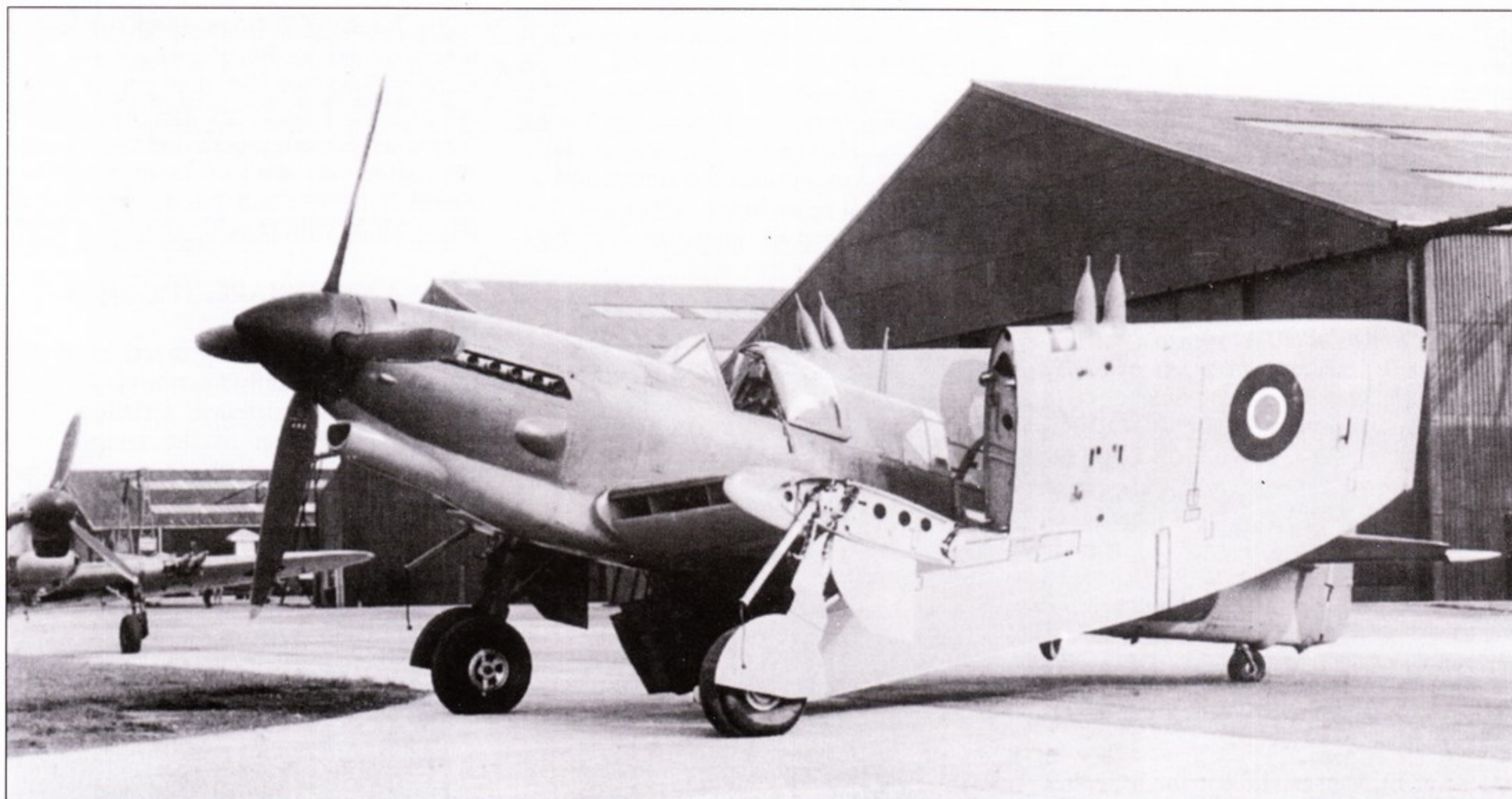
Z2118 - прототип «Файрфлая» Mk.4 в ожидании радара и подкрыльевых топливных баков. Главным различием между опытным образцом и первыми серийными Mk.4 был больший по размерам воздухозаборник карбюратора.
