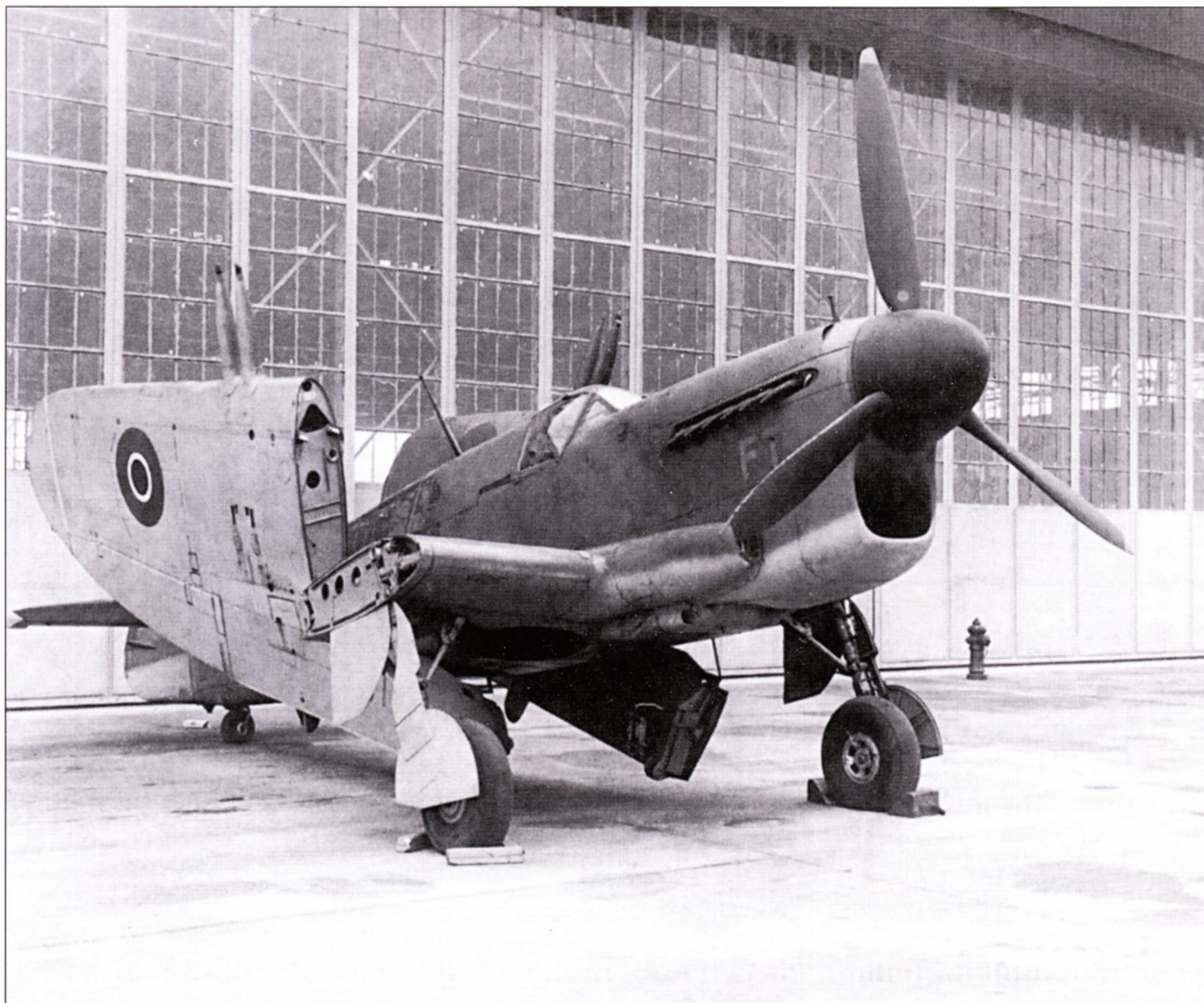
Складывающиеся консоли крыла крепились только к заднему лонжерону, поворачиваясь таким образом, чтобы выступающие части закрылков оказались под центропланом. Эта фотография «Файрфлая» F.1 Z1908 сделана в США, во время сравнительных испытаний на Joint Fighter Conference.
