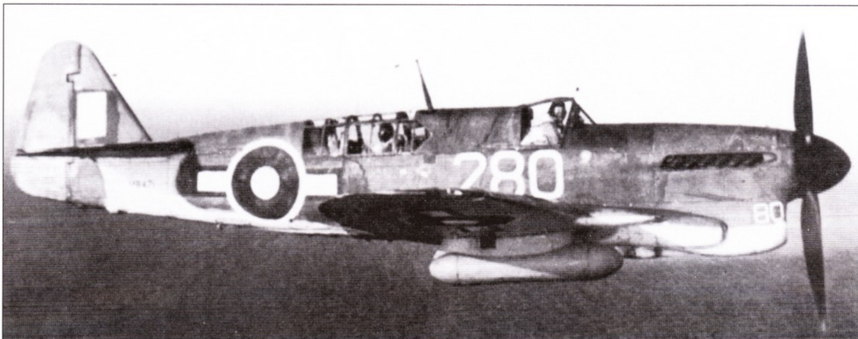
МВ471 «280» 1772-й эскадрильи в разведывательном полете с 170-литровым подвесным топливным баком. Триколор на киле закрашен. «Файрфлай» I мог нести в дальних вылетах 170 или 340-литровые подвесные баки.
