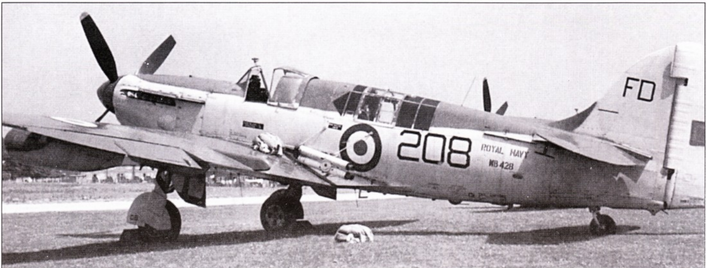
«Файрфлай» AS.5 WB428 («208/FD»), оснащенный стартовыми ускорителями RATO, Форд, 1954 год. Варианты нанесения кодов варьировались от подразделения к подразделению. Две последние цифры бортового номера продублированы на щитках шасси.
