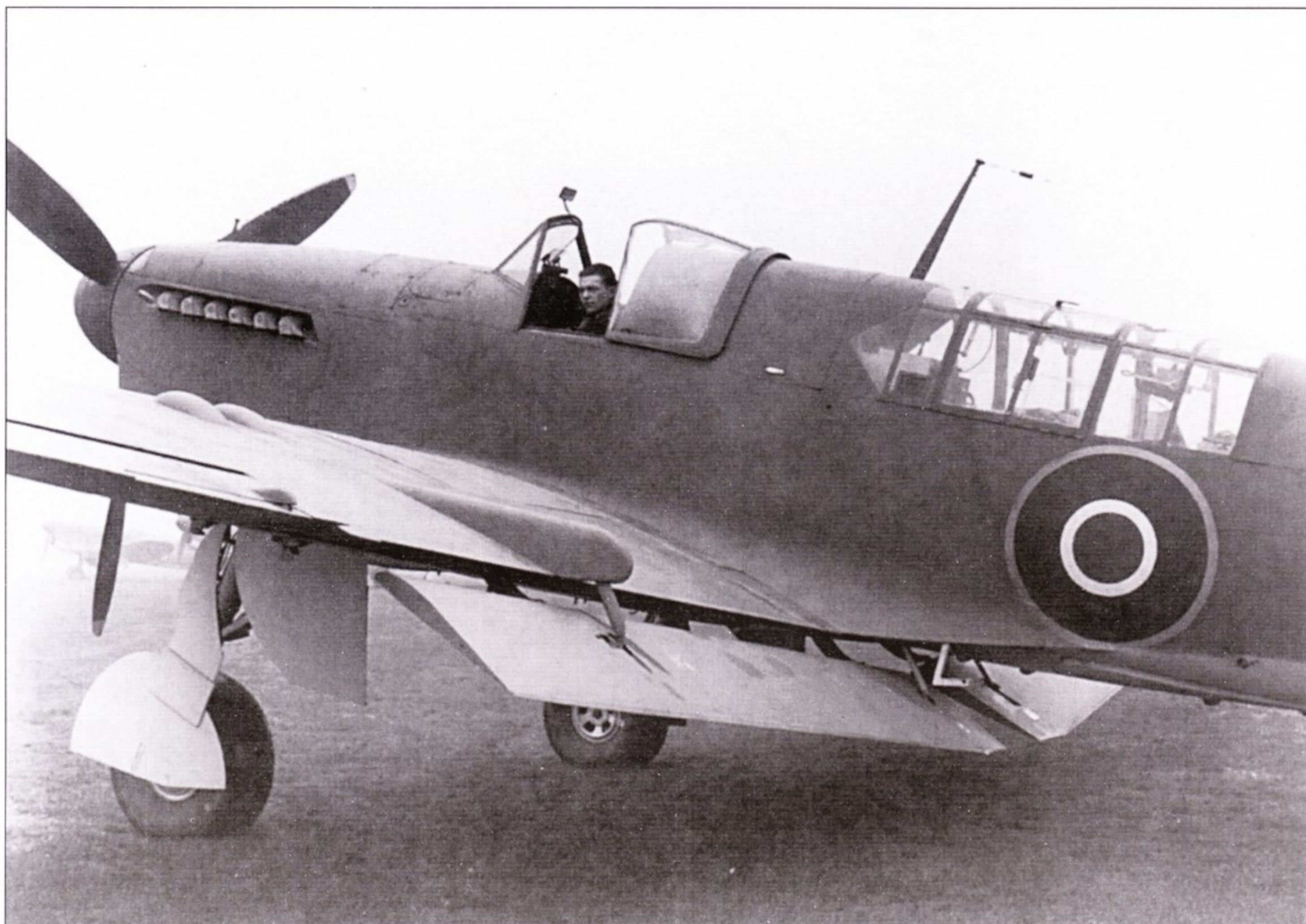
Закрылки Фэйри-Юнгмена, когда были выпущены в маневренное положение, резко улучшали маневренность истребителя, делая его грозным оружием в руках опытного пилота.
