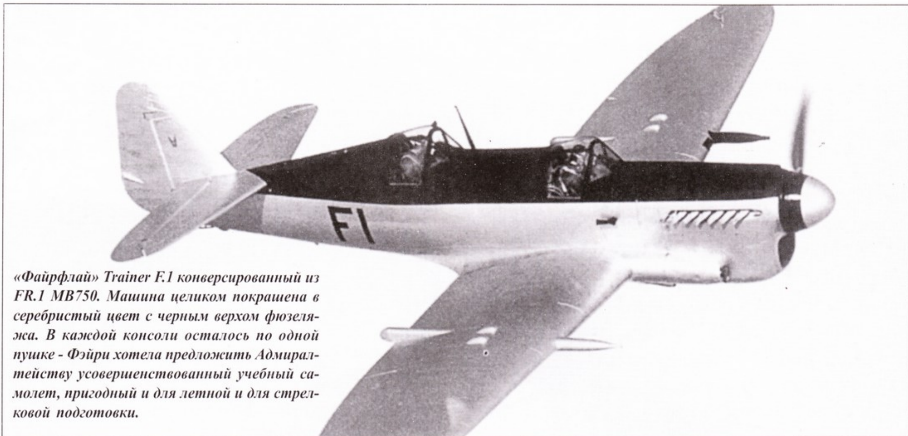
Посадочный крюк с самолета еще не снят. Обе кабины имеют высокий ветровой козырек.
