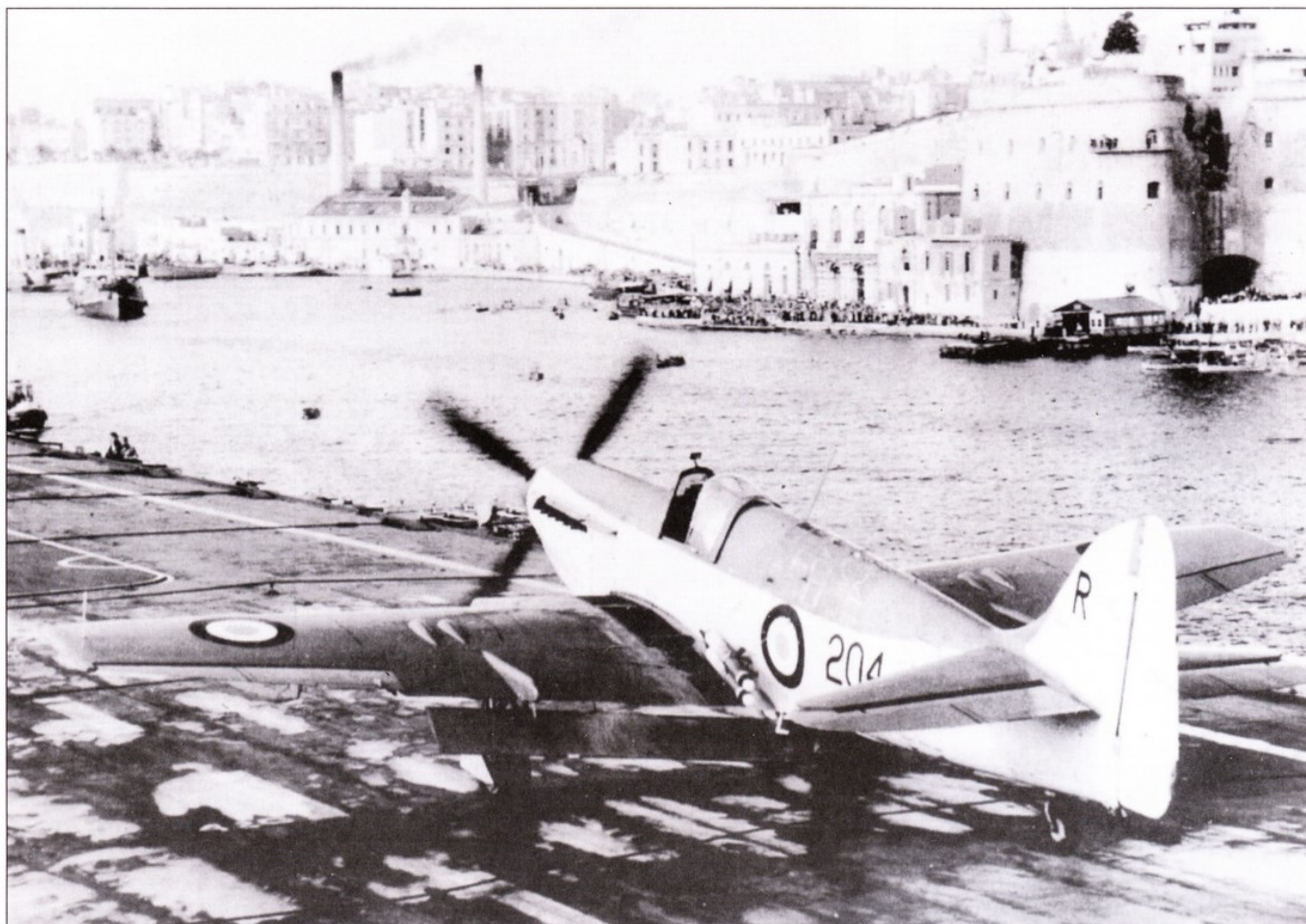
Население Мальты любит красивые зрелища. Сотни людей собрались на берегу Грэнд Харбор, когда стало известно, что «Файрфлай» FR.5 812-й эскадрильи впервые взлетит с палубы стоящего авианосца с помощью ракетных ускорителей RATOG (Rocket Assisted Take-off Gear). Несколько минут спустя самолет приземлился в Хал Фаре.
