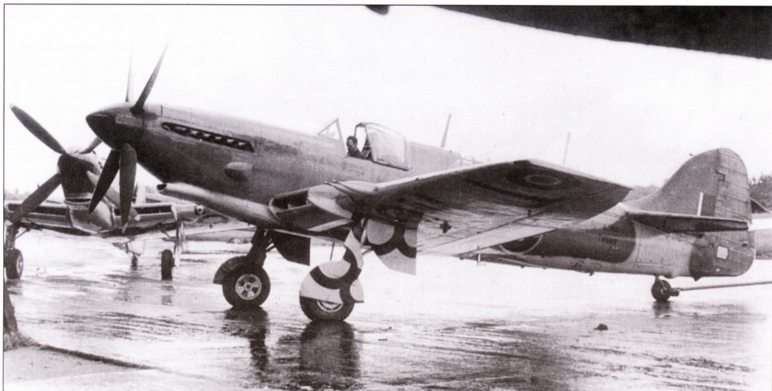
Первые «Файрфлай» Mk.4 были переделаны из оставшихся на сборочной линии планеров Mk.1. Оба самолета на фотографии еще имеют носовой воздухозаборник старого типа, канал которого в дальнейшем был удлинен для улучшения аэродинамики.
