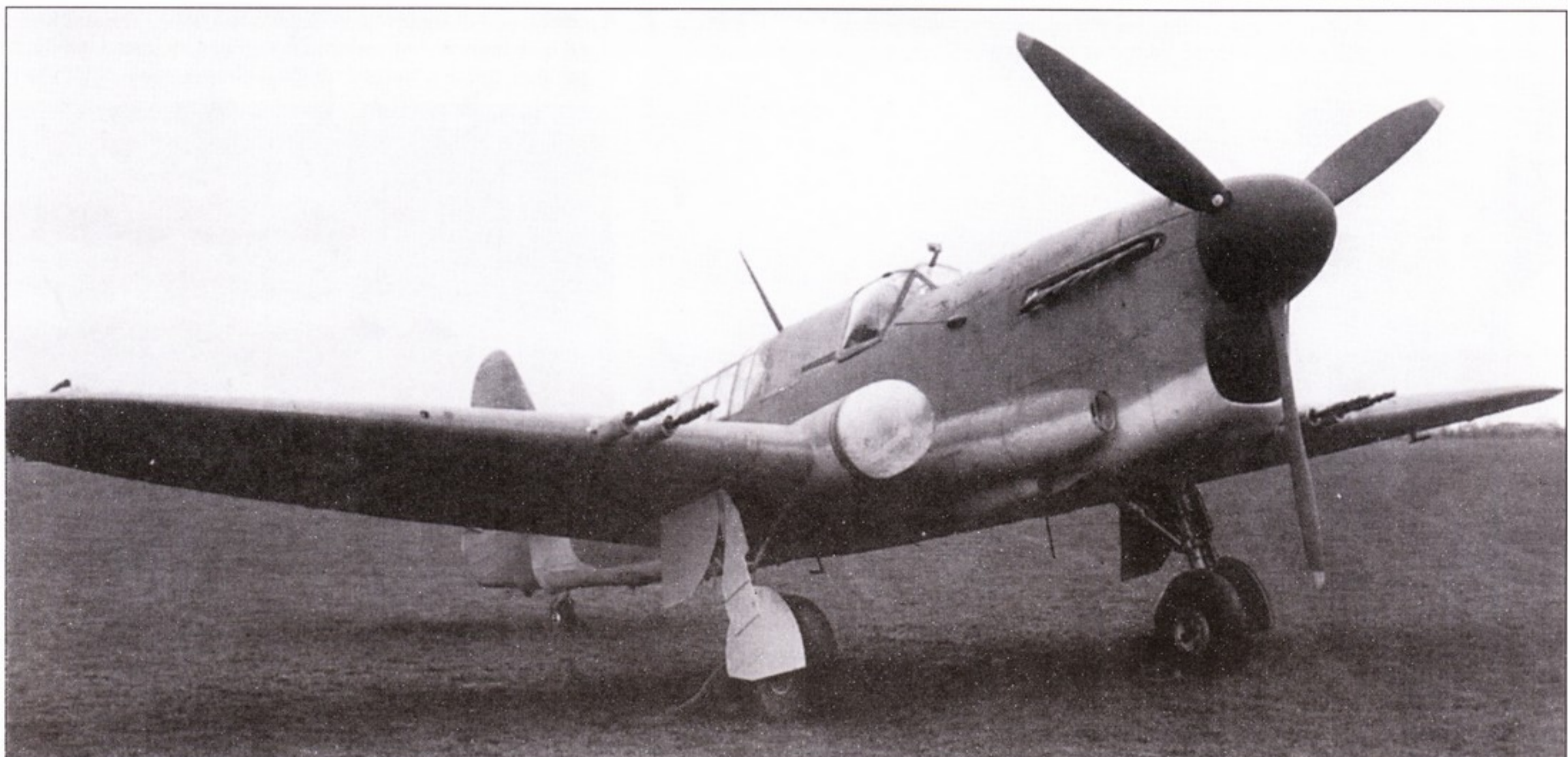
Z1831/G сфотографированный в 1944 году, когда укоротили обтекатели антенн радара. Эта модификация оказалась неудачной и большинство из 37 построенных машин переделали в FR.1.
