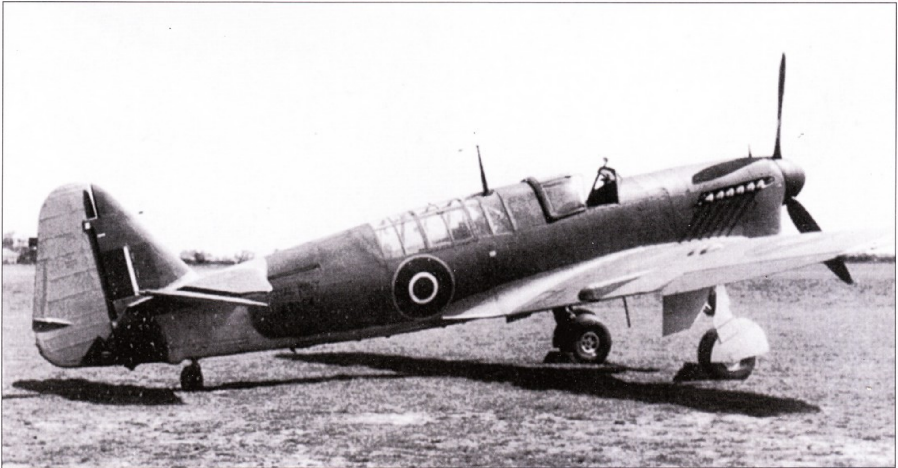
Один из первых предсерийных «Файрфлаев» на испытательном аэродроме Фэйри Хайес, Западный Лондон. Низкий фонарь кабины, пушки без обтекателей, трехлопастной винт и поверхности управления обшитые полотном - характерные признаки этих машин.
