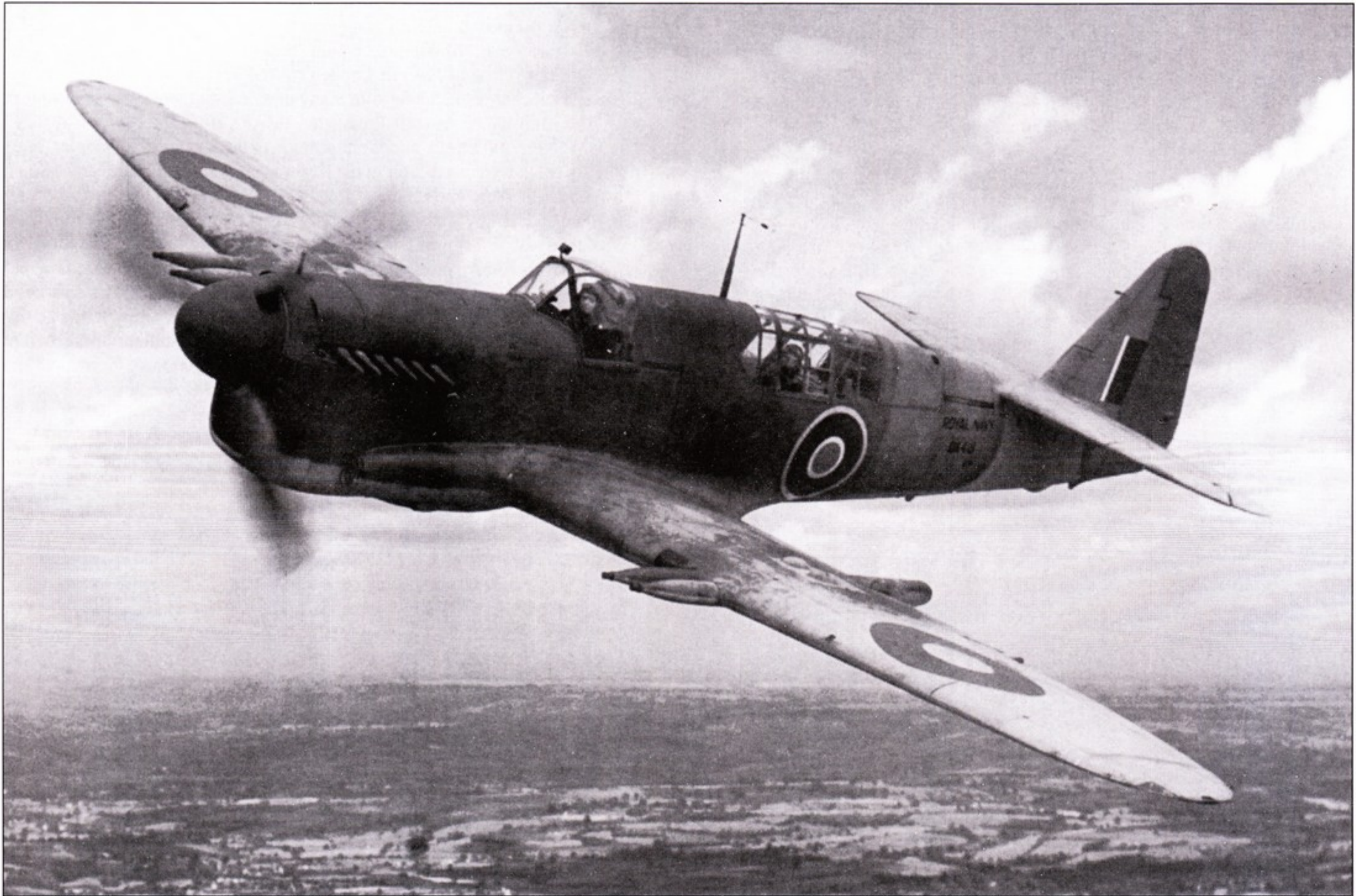
«Файрфлай» FR.1 DK418, поступивший на вооружение 790-й эскадрильи в декабре 1944 года. Это машина позднего выпуска с высоким ветровым козырьком и выпуклым фонарем кабины.
