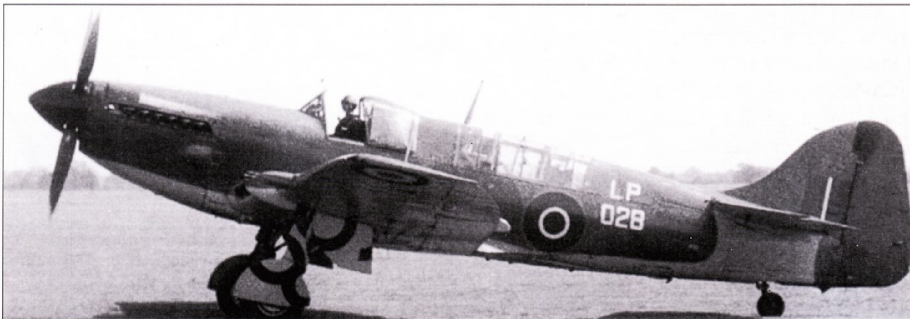
«Файрфлай» Mk.4 VG968 проходил интенсивные испытания в 778-й эскадрилье, базировавшейся в Ли-он-Солент. Это испытательное подразделение одним из первых получало новые самолеты FAA. Подкрыльевые гондолы с машины сняты.
