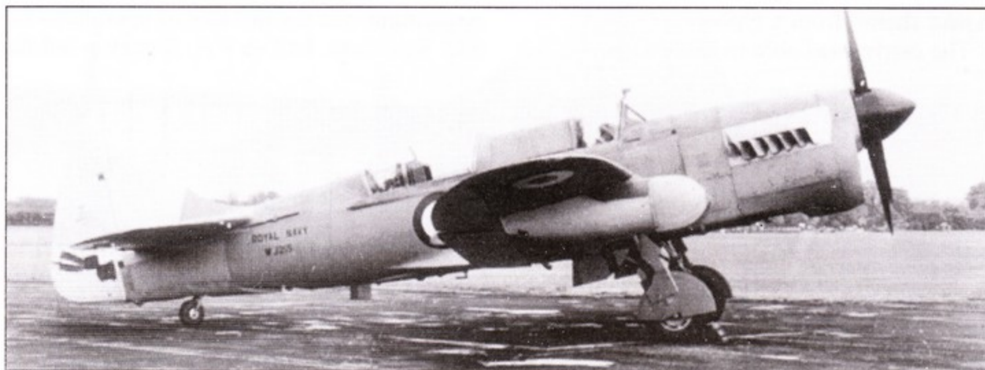
«Файрфлай» WJ215 был первым прототипом AS.7. Он был сделан на базе планера AS.6 и имел старое хвостовое оперение, которое не обеспечивало боковой устойчивости, нарушившейся после введения носового радиатора.
