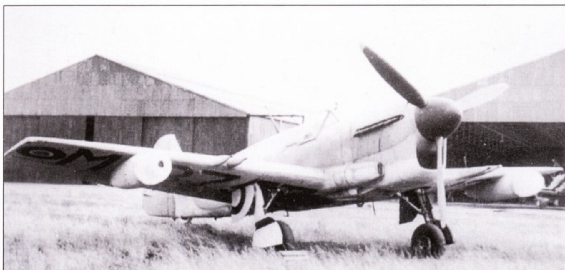
Этот «Файрфлай» F.1 получил подкрыльные гондолы для испытательных целей. Они отличались по форме от устанавливаемых на Mk.4. Самолет имеет крыло с укороченными законцовками.
