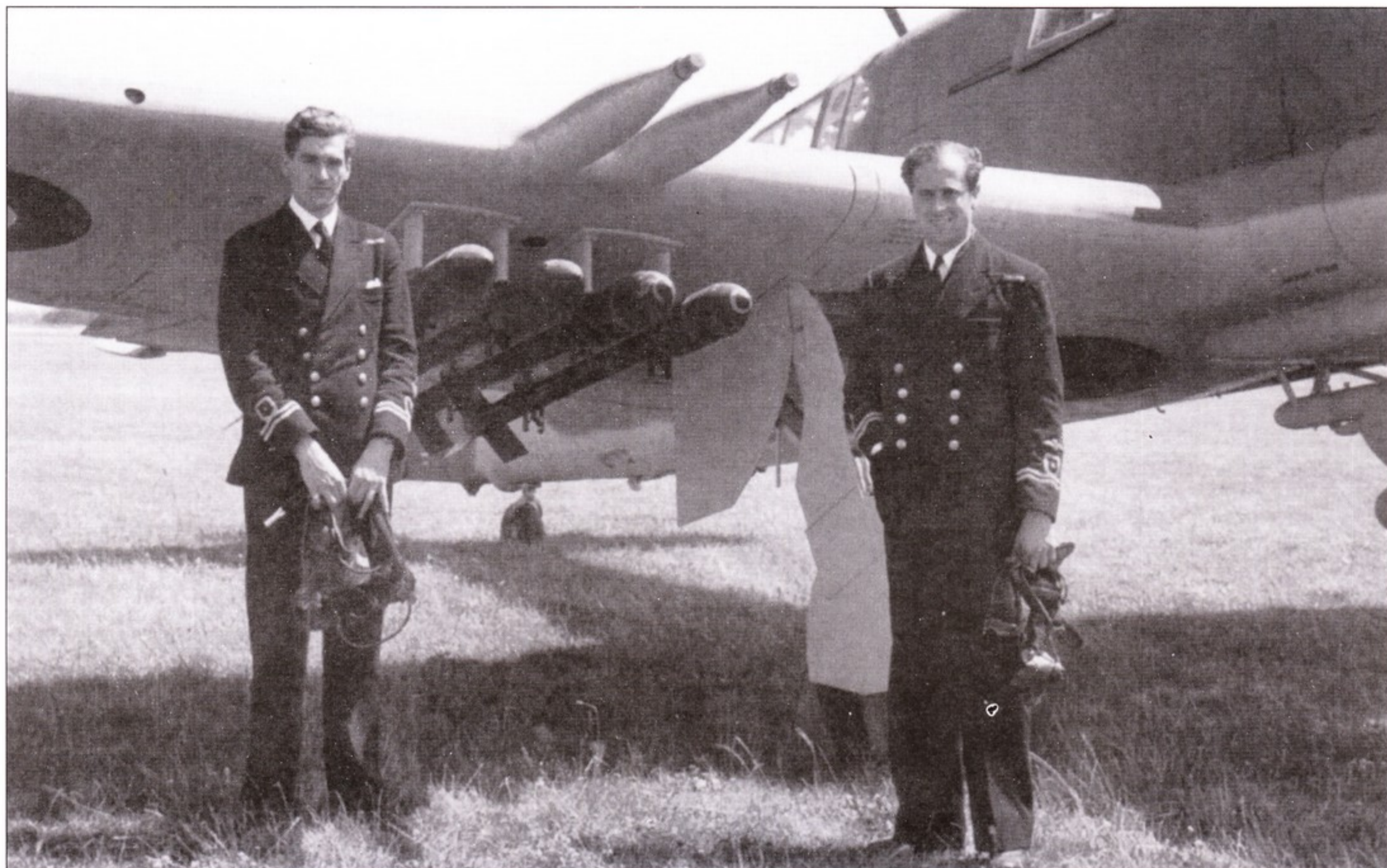
Пилот и наблюдатель FAA, позирующие на фоне «Файрфлая» FR.1, дают возможность оценить размеры самолета. НУРСы (RP) подвешены на держателях Mk.VIII, требовавших двух переходников для установки каждой ракеты - одного спереди и одного сзади. НУРСЫ могли устанавливаться в два яруса при наличии специальных переходников. 27,22-кг боеголовки целиком окрашенные в темно-зеленый цвет - бронейбойные, а с белыми кольцами - осколочно-фугасные.
