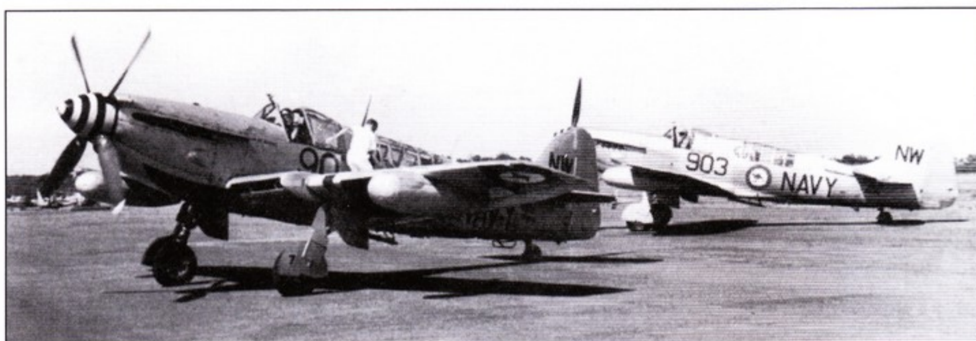
Два «Файрфлая» TT.6, WJ109 («907/NW») и WB518 («903/NW»), из австралийской 851-й эскадрильи готовятся к возвращению с аэродрома Бэнкстаун на свою базу в Новра. Буксировщики мишеней были покрашены в серебристый цвет с черными и желтыми полосами на нижних поверхностях и коках винтов. К этому времени на австралийских кокардах появилось изображение кенгуру. Код «NW» на киле указывает принадлежность машин базе Новра.
