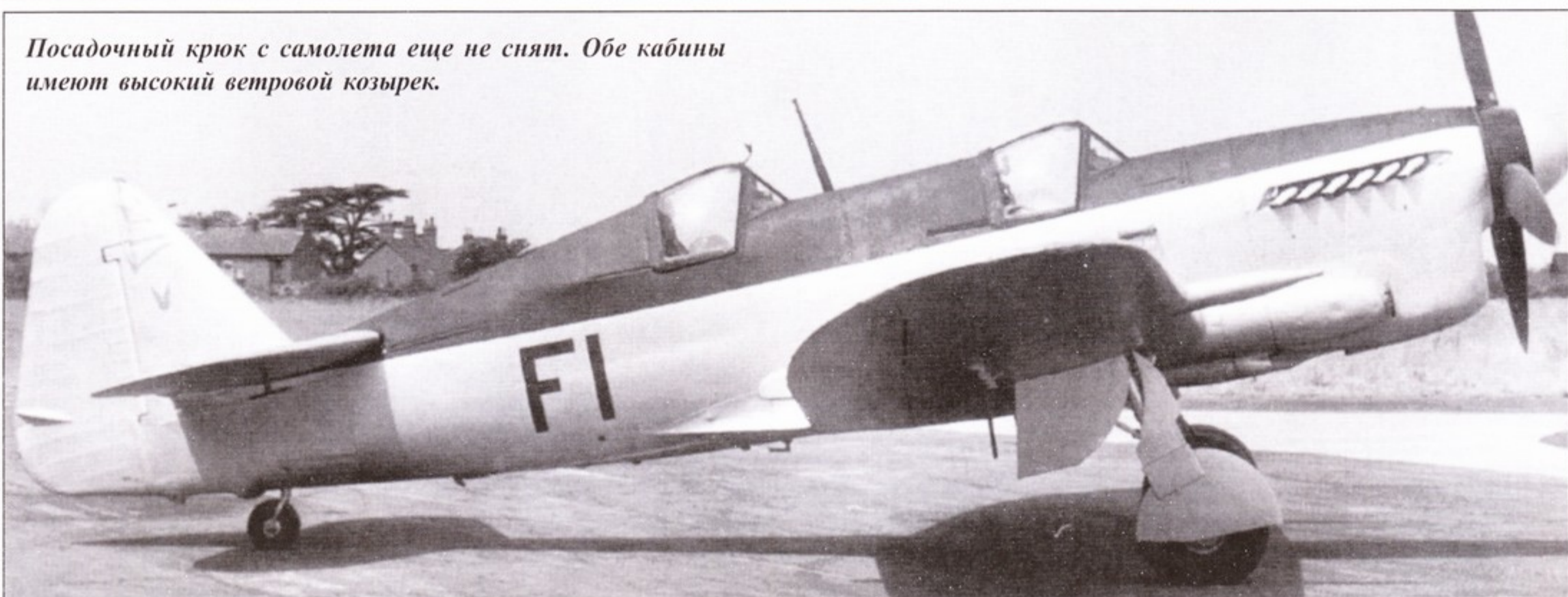
«Файрфлай» Trainer F.1 конверсированный из FR.1 MB750. Машина целиком покрашена в серебристый цвет с черным верхом фюзеляжа. В каждой консоли осталось по одной пушке - Фэйри хотела предложить Адмиралтейству усовершенствованный учебный самолет, пригодный и для летной и для стрелковой подготовки.
