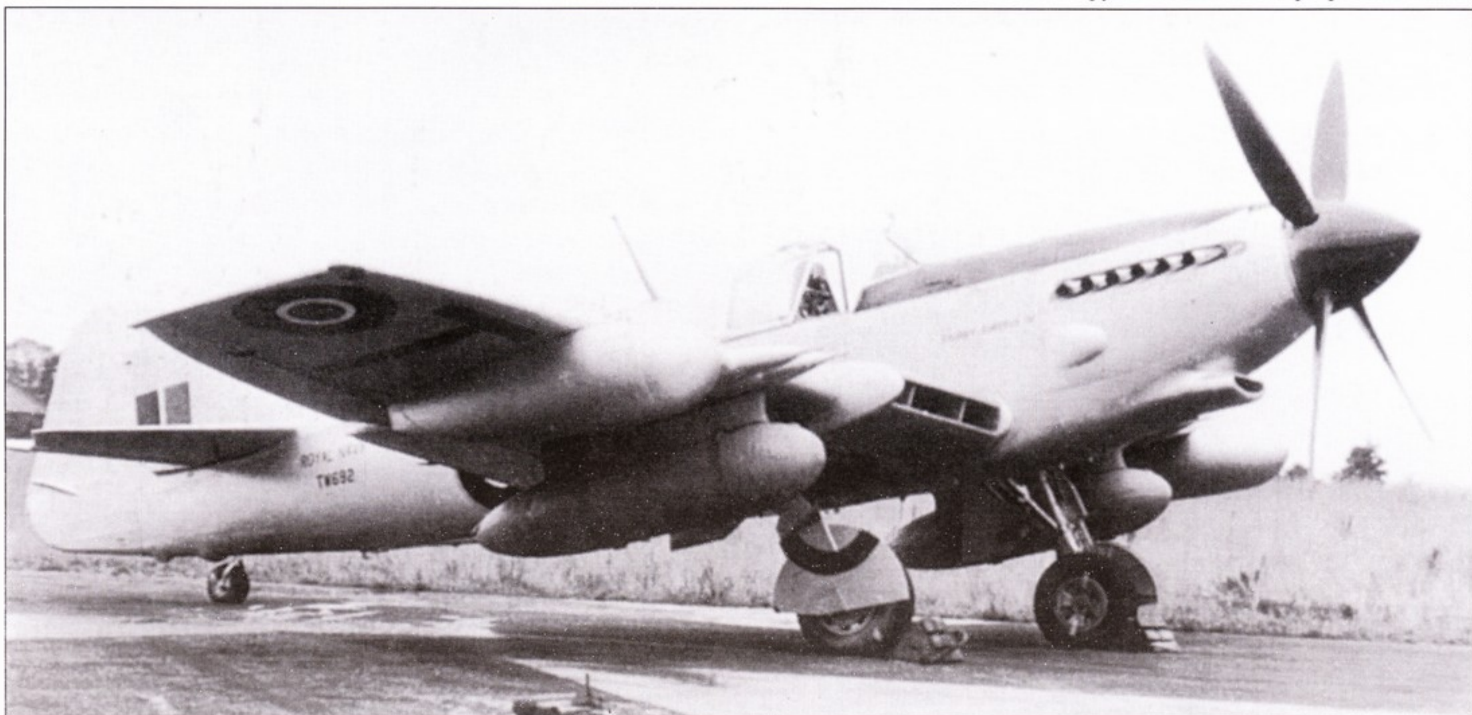
«Файрфлай» T.4 TW692 остался у Фэйри и в 1948 году использовался для демонстрационных полетов по Ближнему Востоку. Хотя Египет и Ирак проявили интерес к машине, в дальнейшем заказов не последовало. На снимке видны дополнительные топливные баки.
