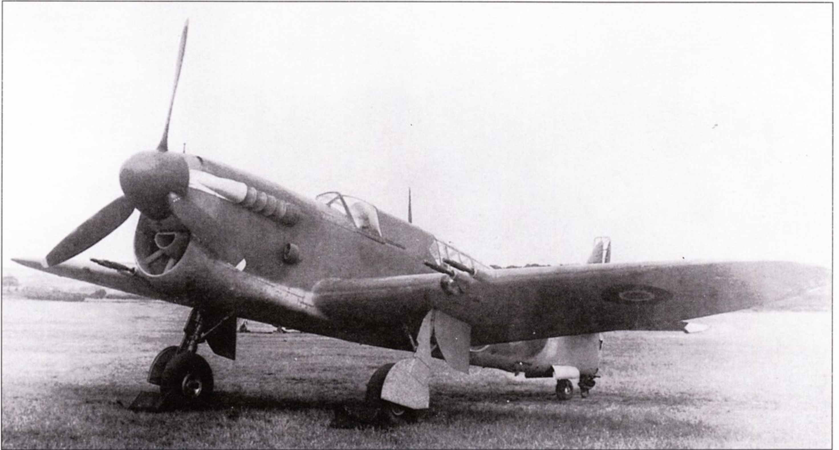
Неудачный «Файрфлай» F.3 был сделан путем установки мотора Роллс-Ройс «Грифон» 61 на «Файрфлай» F.1 Z1835. F.3, задуманный как одноместный истребитель имел недостаточную устойчивость и от его дальнейшей разработки отказались. Установка нового мотора потребовала увеличить размеры радиатора и поставить новые пламегасители, что хорошо видно на снимке.
