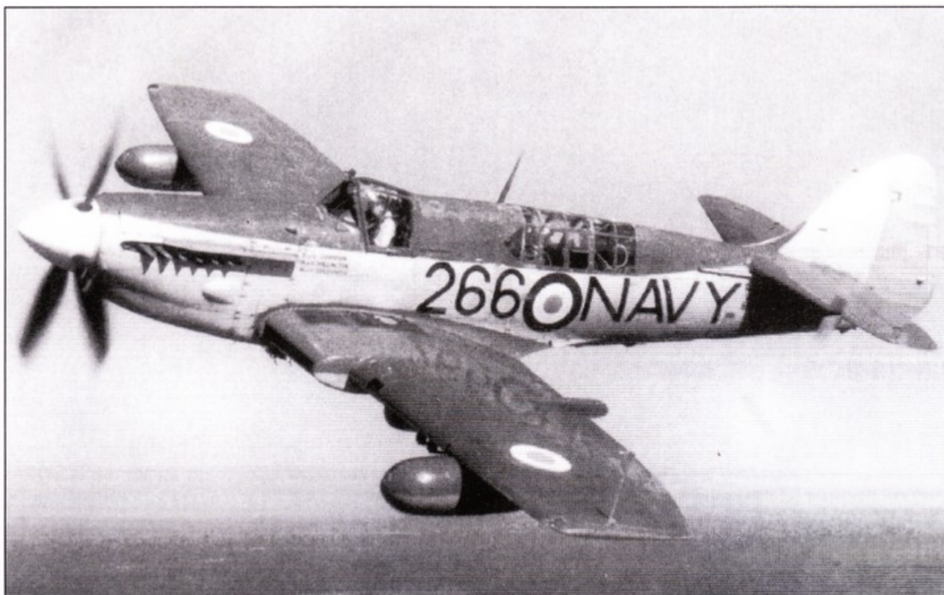
«Файрфлай» Firefly AS.6 WD884 («266») ВМС Австралии демонстрирует как австралийцы наносили бортовые коды на свои машины в последний период их эксплуатации. Вслед за англичанами ВМС Австралии отказались от триколора на киле. Над выхлопными патрубками установлены щитки, а на борту, чуть ниже ветрового стекла, нанесены имена членов экипажа.
