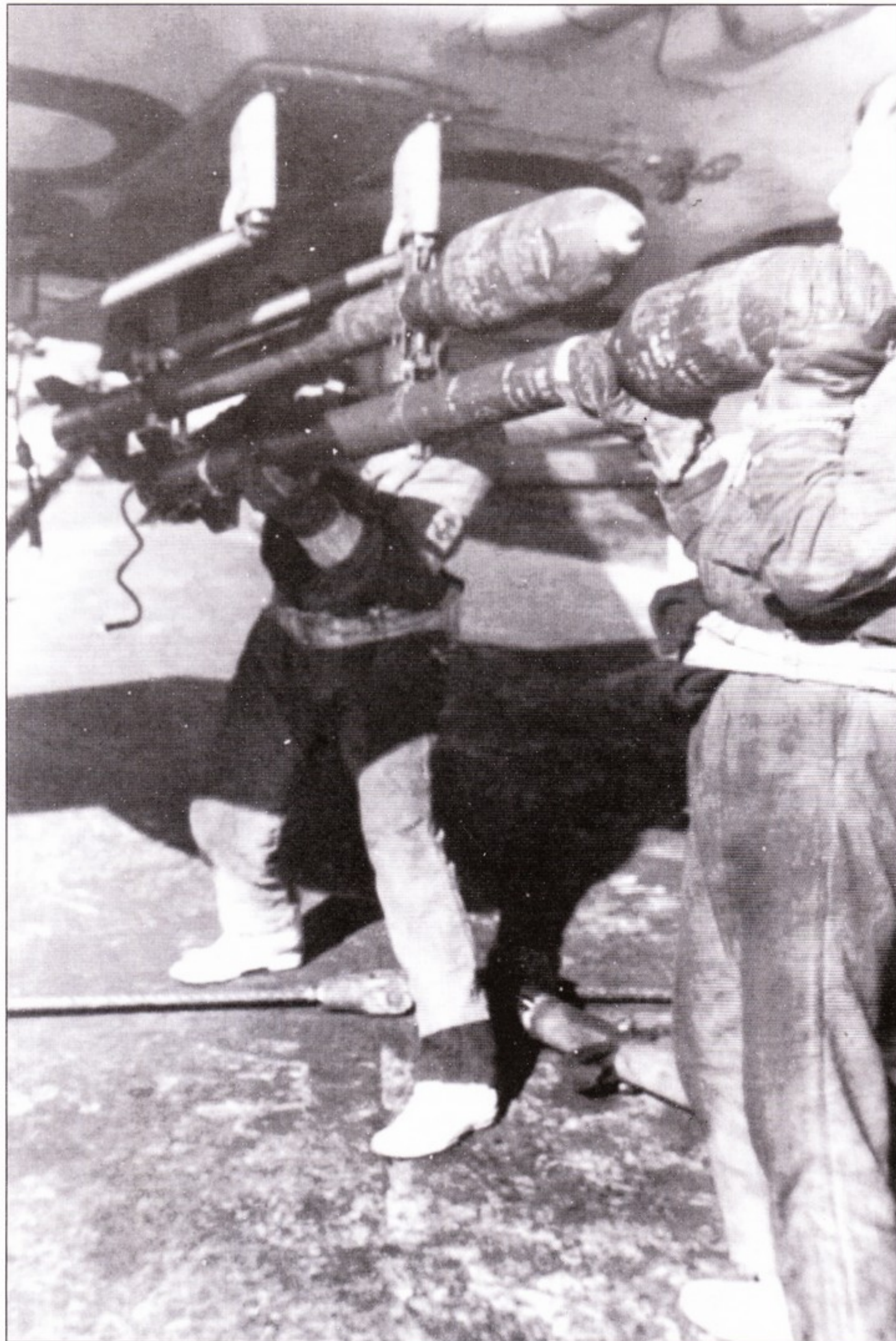
Подвеска 76-мм НУРС на «Файрфлай» FR.5 821-й эскадрильи. Ракеты целиком, включая 27-кг боеголовку, окрашены в темно-зеленый цвет. Подвешенные в два яруса НУРСы пускались залпами по две ракеты.
