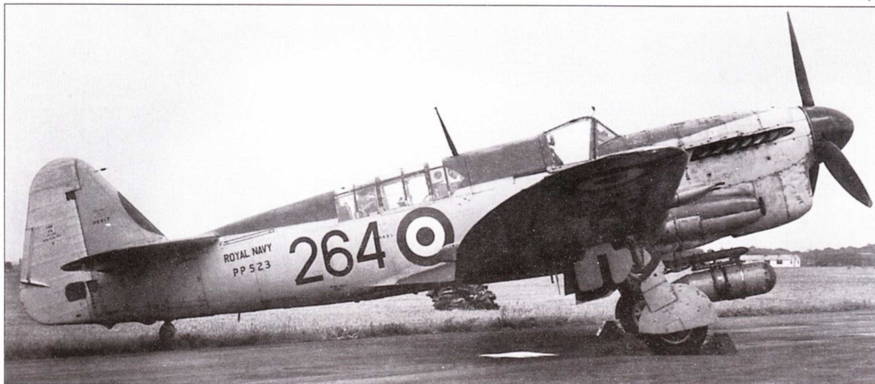
Фотография строевого «Файрфлая» FR.1, PP523, «264» из 796-й эскадрильи с радаром ASH (Air-to Surface Homing) в контейнере под носовой частью фюзеляжа, 1952 год. Можно заметить, что ось контейнера слегка отклонена вниз от продольной оси самолета. Верхняя поверхность фюзеляжа окрашена в Dark Sea Grey, включая небольшой участок на передней кромке киля. Обратите внимание на отсутствие британского триколора на киле, которые перестали наносить на самолеты морской авиации с конца 1940-х годов.
